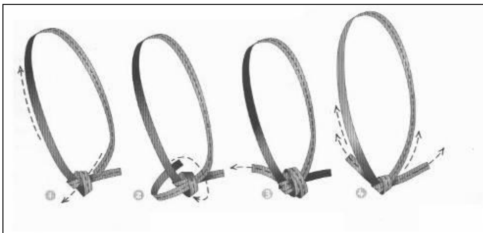
گره تسمه (Water Knot): اتصال دو سر نوار (تسمه).
