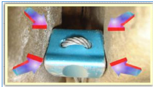
درگیر شدن موثر یک استاپر در داخل شکاف
