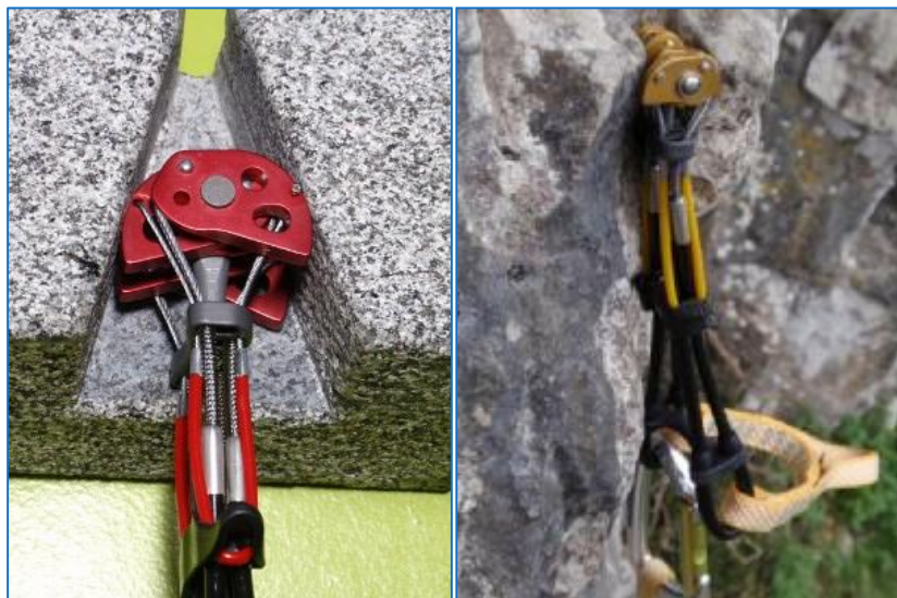
Totem cam ابزاری با قابلیت درگیر شدن فقط دو بادامک و بهترین نوع فرند برای شکافهای کلوش
