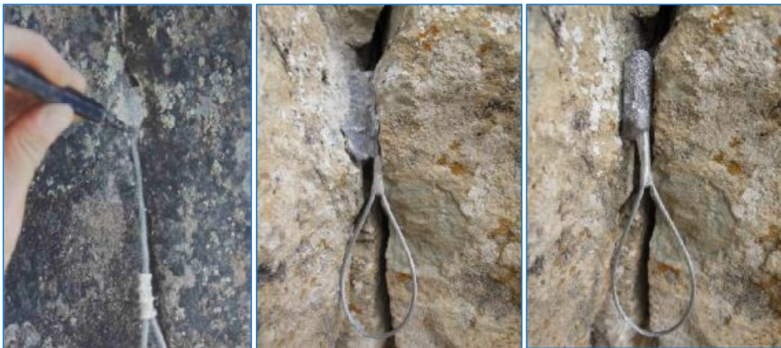
ابزار کاپرهد قبل و بعد از کوبیده شدن در داخل شکاف
