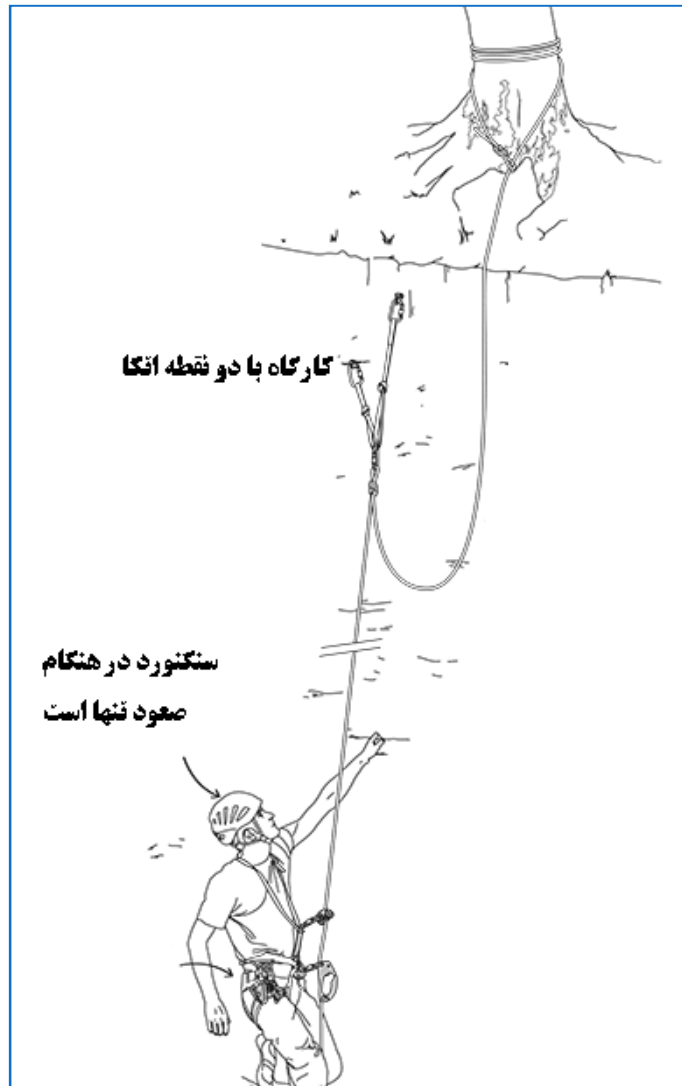
صعود بر روی طناب ثابت . در نقاط سایش حتماً باید ریبلی ( حمایت مجدد ) ایجاد نماییم.
